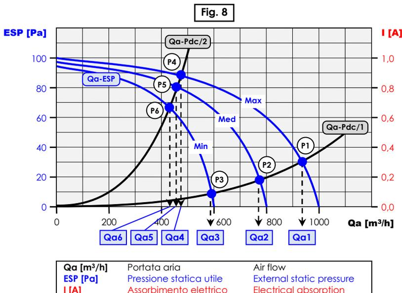
Qualora una unità a 3 velocità (max-med-min) venga collegata ad un impianto aeraulico con curva delle perdite di carico "Qa-Pdc/1", i punti di funzionamento alle 3 velocità diventano P1-P2-P3, con portate aria Qa1-Qa2-Qa3 ben distinte e separate.
