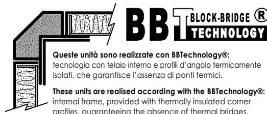
Queste unità sono realizzate con BBTechnology®: tecnologia con telaio interno e profili d'angolo termicamente isolati, che garantisce l'assenza di ponti termici.
